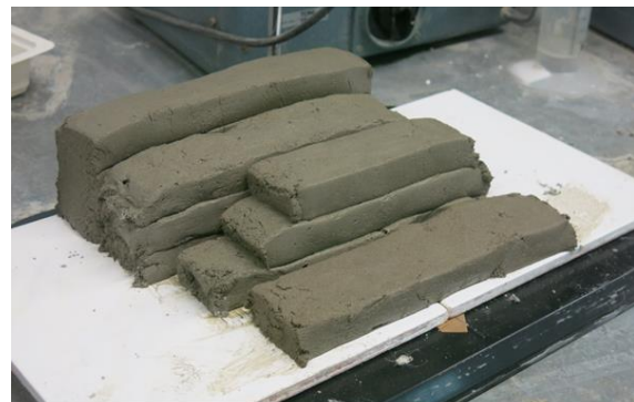
Beton csík rövidhasábok laboratóriumi nyomtatása (2021)
