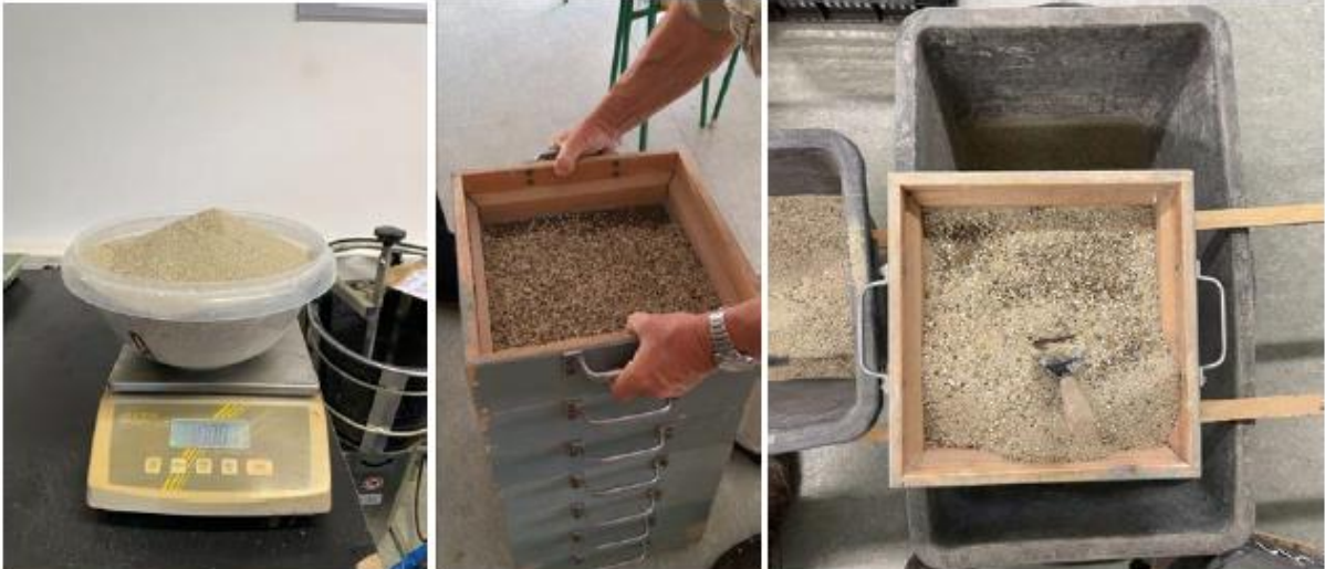
0/4 homokos kavics szemszerkezetének laboratóriumi vizsgálata
