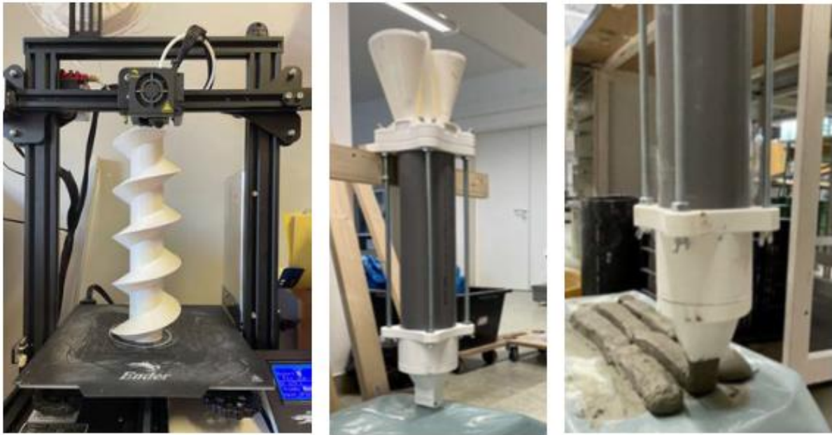
A laboratóriumi nyomtatófej legyártása és próbanyomtatások végzése
