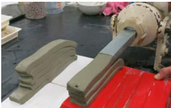
Beton csík rövidhasábok laboratóriumi nyomtatása (2021)
