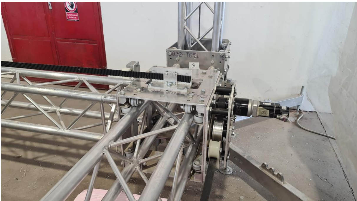
a nyomtató hajtása, és az „X”, illetve a „Z” irány kocsi
