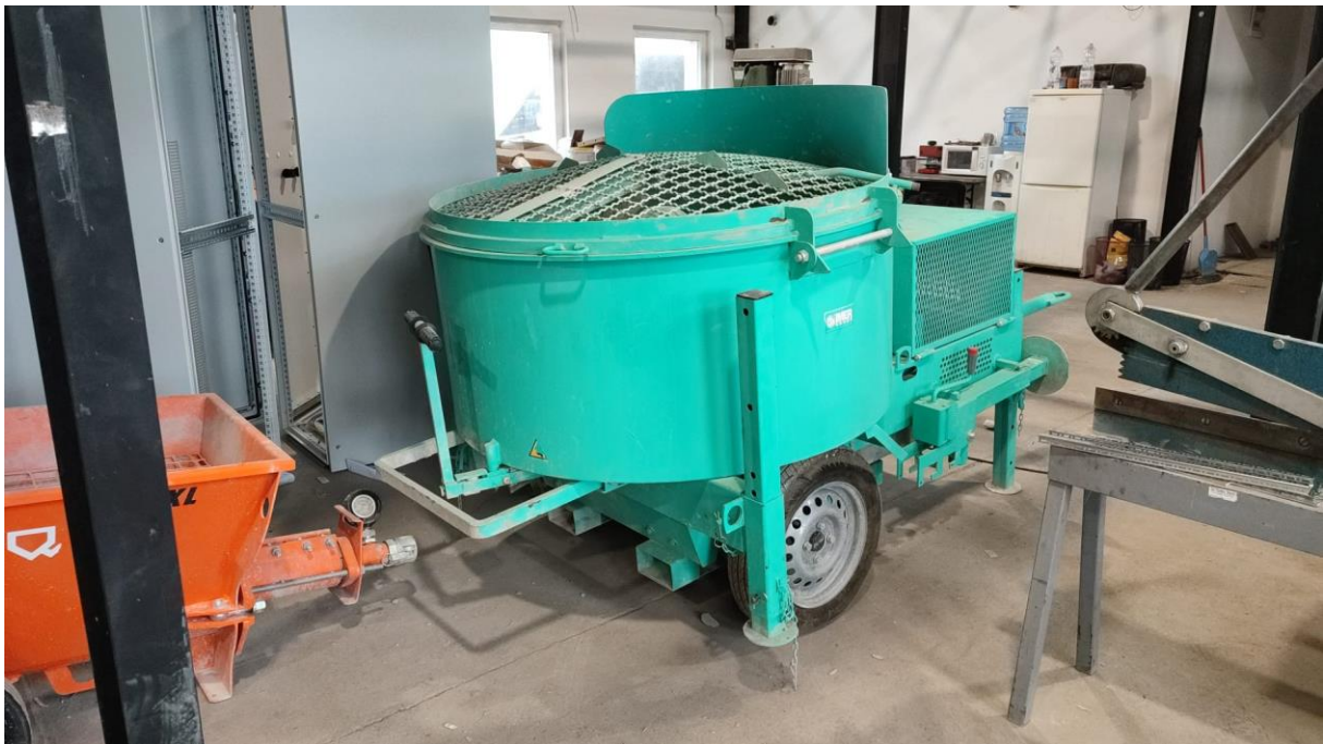
Ezen a képen a kényszerkeverő berendezés látható, itt kerül összeállításra az előre meghatározott receptúra alapján a nyomtató anyag, amely megfelelő keverést követően továbbításra kerül a habarcs pumpába, ami a továbbítást végzi
